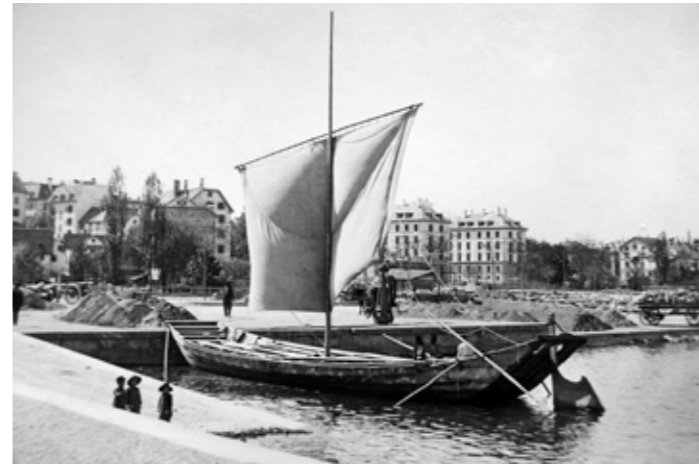
Ledischiff im Hafen Riesbach, Zürich, um 1890. Viele Bau- und Ausrüstungsdetails sind auf dieser seltenen Fotografie gut auszumachen.
